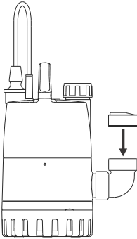
8. ábra A visszacsapó szelep helyes pozicionálása
