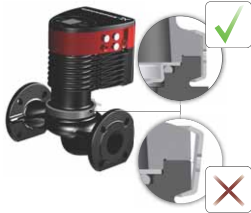
9. ábra A szivattyúfej felszerelése a szivattyúházra
